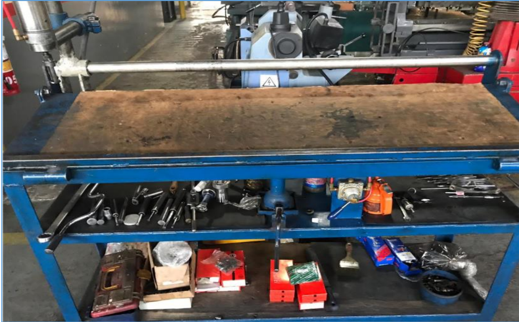
Imagen 2. Mesa de herramientas 5 del área de “Rectificado” una vez adoptada la metodología de las 5S's.
