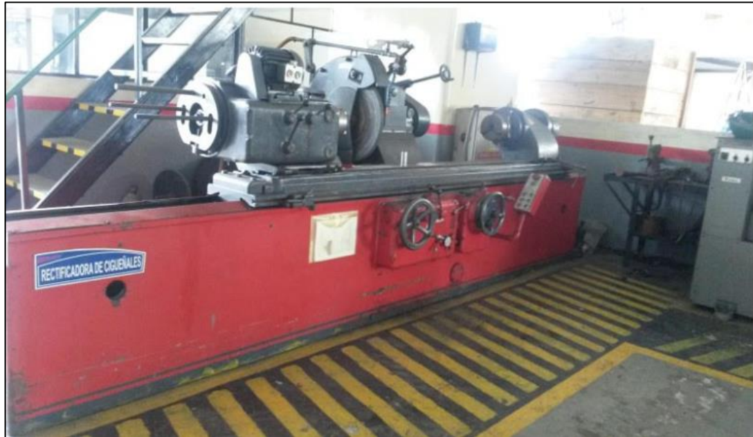
Imagen 6. Señalización de la zona de tránsito peatonal junto a la Máquina Rectificadora de Cigüeñales, en el área de “Rectificado”, una vez adoptada la metodología de las 5S’s.
