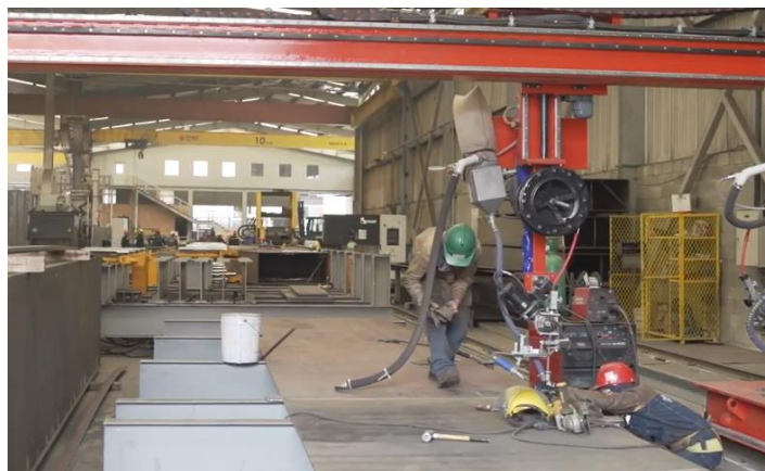
Imagen 3. Procesos de fabricación de estructuras metálicas KG1
