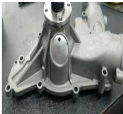
Imagen 5: Remplazo de bomba de agua Fuente: OBRECO Cía. Ltda.
