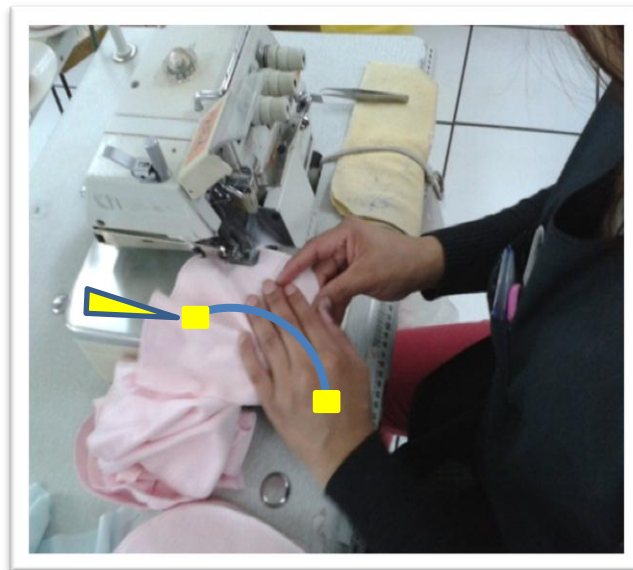
Figura N° 34: Proceso de costura con máquina overlock
