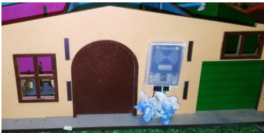
Figura 25. Lector magnético de apertura de puerta.
