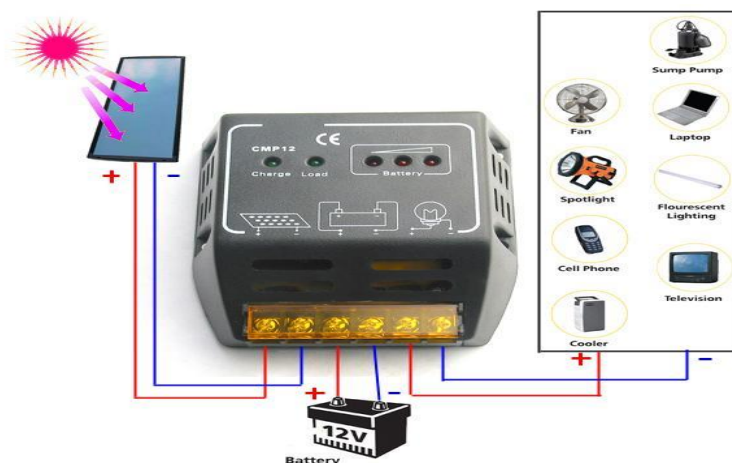
Figura 10 Regulador de carga de un sistema fotovoltaico
