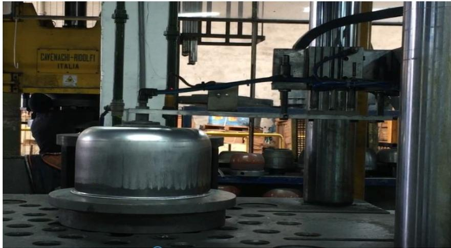
**Figura 37.- Cilindro de transporte banda estación de corte y bordeo**
