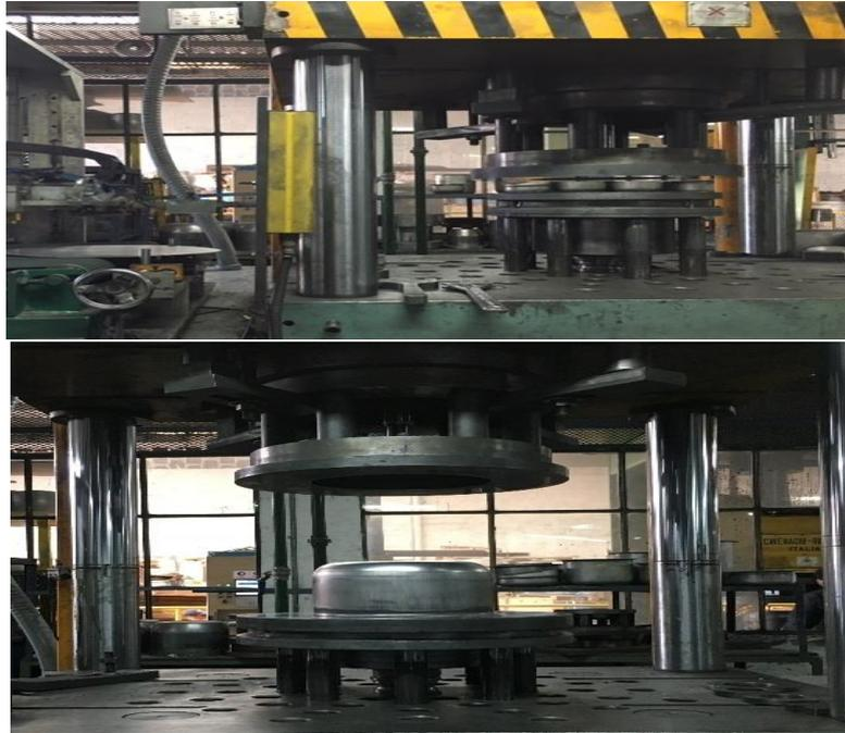
**Figura 35.-** Embutición de caldero y brazo de movimiento
