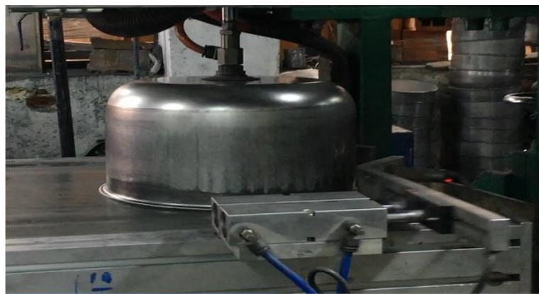
**Figura 36.-** Estación de corte y bordeado
