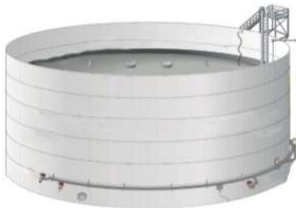
Figura 4 Tanque de techo flotante
