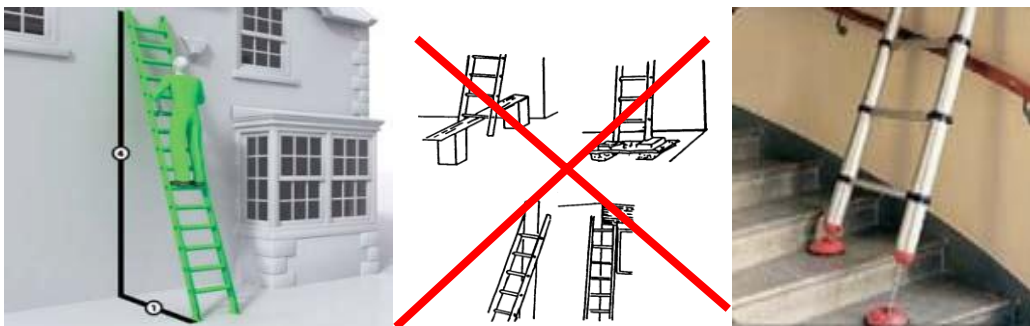
Figura No. 34: Colocación de escaleras Fuente: Propia Elaborado por: El investigador
