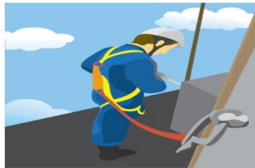
Figura No. 31: Puntos de anclaje Fuente: Propia Elaborado por: El investigador
