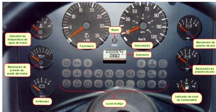
Figura 80: Tablero de instrumentación de la cabina
