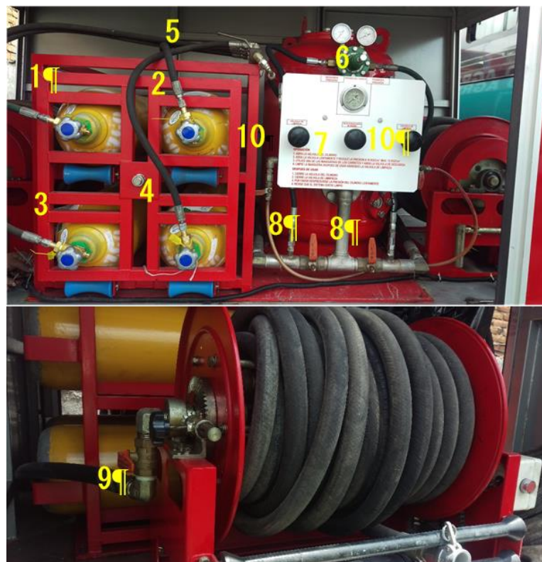
Figura 123: Partes del sistema polvo químico seco de la bomba Morita
