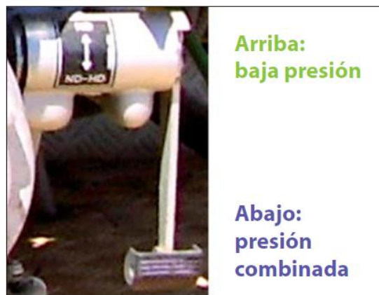
Figura 117: Válvula selectora baja o presión combinada.
