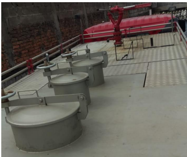
Figura 102: Tapa del tanque de agua de la autobomba
