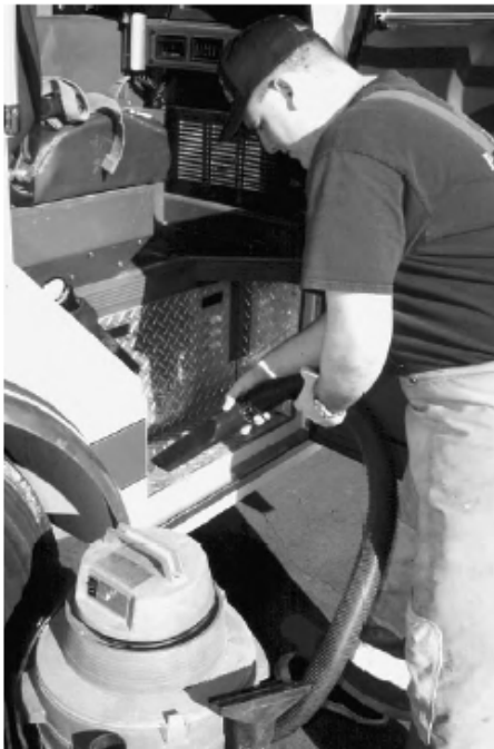
Figura 3.5 Barra o aspire el interior de la cabina.
