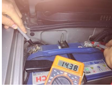
Figura 90: Medición de voltaje de la batería después de encender el motor
