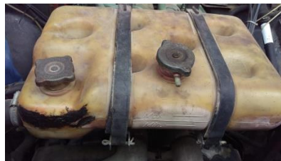
Figura 77: Reservorio de líquido refrigerante de la autobomba BRAVO 1
