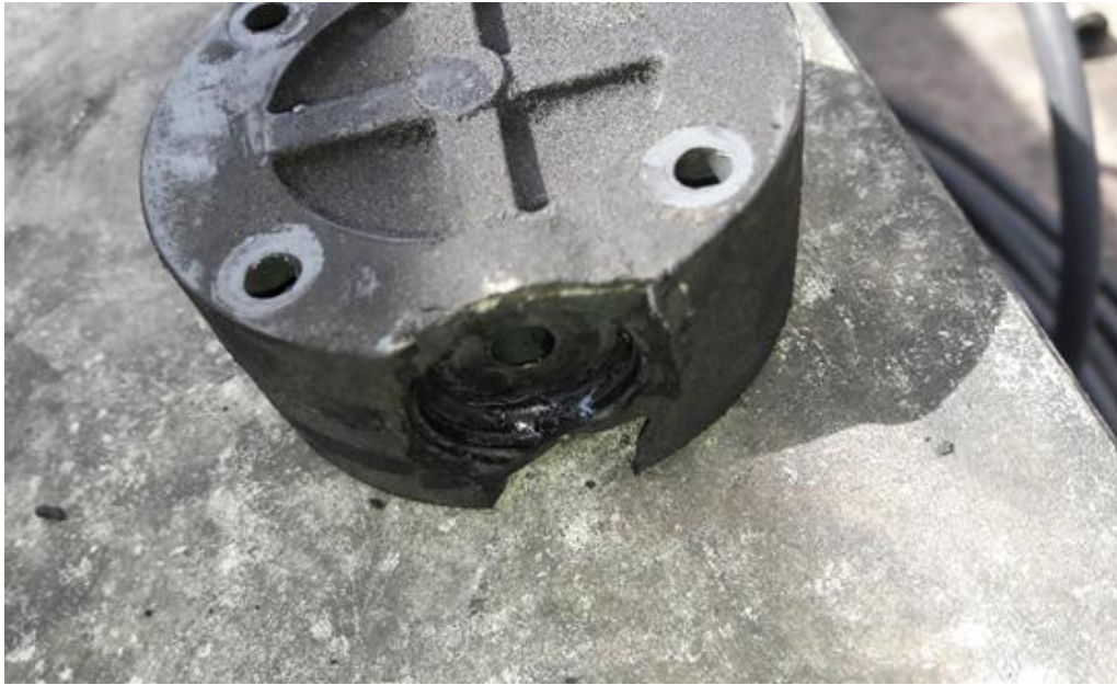
Figura N° 31: Cabezal reactivo del dosificador.
